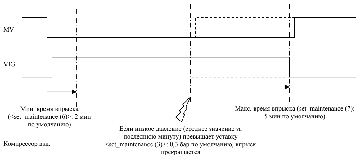
Рис. 14. Логика управления выпрыском горячего пара
